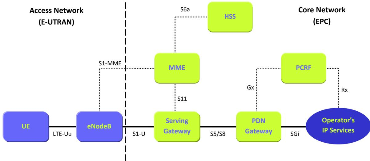
**FIGURE 1 THE EPS NETWORK ELEMENTS.**
